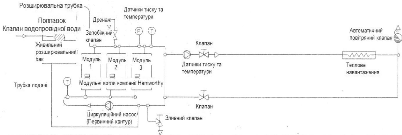
ВІДКРИТА СИСТЕМА: Первинний контур; система, рекомендована компанією Hamworthy.
