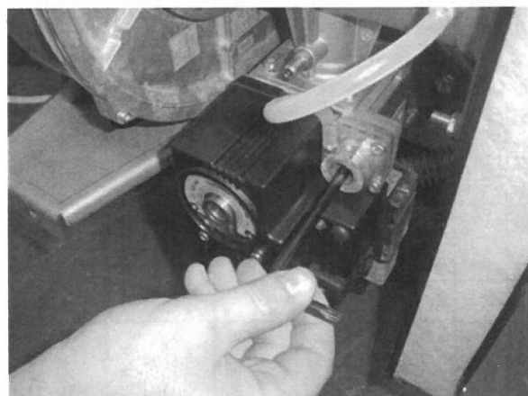
Малюнок 8.6.5 – Регулювання зміщення заслінки газового клапана
