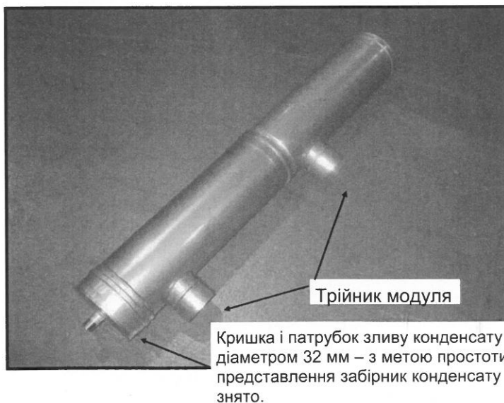
Малюнок 5.2 – Димовий колектор в зібраному вигляді
